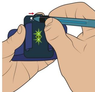
Jos haluat kytkeä anturin pois päältä välttääksesi akun tyhjenemisen, kytke anturi pois päältä ON/OFF-kytkimellä. Anturi ei voi latautua, kun se on kytetty pois päältä.
