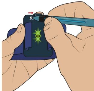
Om du vill stänga av sensorn för att förhindra att batteriet tar slut, använder du On/OFF-omkopplaren för att stänga av sensorn. Sensorn kan inte laddas när den är avstängd.
