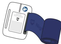
Den elastiske strop skal justeres til størrelsen på brugerens overarm. Den ene side af den elastiske strop er allerede monteret i sensoren.
