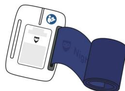
Den elastiske stroppen bør justeres til størrelsen på brukerens overarm. Den ene siden av den elastiske stroppen er allerede montert i sensoren.
