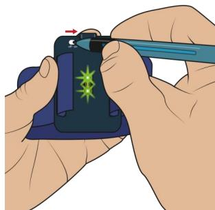
Hvis du ønsker at slukke for sensoren for at forhindre, at batteriet løber tør, skal du bruge ON/OFF-kontakten til at slukke for sensoren. Sensoren kan ikke oplades, når den er slukket.
