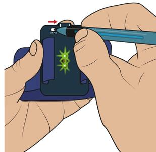
Si vous souhaitez éteindre le capteur pour éviter que la batterie ne s'épuise, utilisez l'interrupteur MARCHE/ARRÊT pour éteindre le capteur. Le capteur ne peut pas se charger lorsqu'il est éteint.
