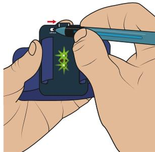
Als de sensor wordt losgekoppeld van de oplader, wordt de detectie van aanvallen gestart.
