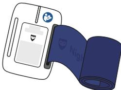
De elastische band moet worden aangepast aan de grootte van de bovenarm van de drager. Eén kant van de elastische band is al in de sensor bevestigd.
