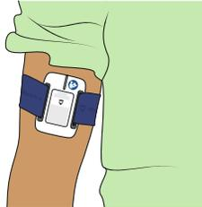
**LET OP:** Voor een zo nauwkeurig mogelijke detectie van epileptische aanvallen moet de sensor op de bovenarm (biceps) en direct op de huid worden gedragen. Als de drager een pyjamatop of ander kledingstuk met lange mouwen draagt, zorg er dan voor dat de mouw wijd genoeg is om de sensor eronder te dragen, anders is detectie van aanvallen niet mogelijk.
