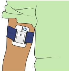
**BITTE BEACHTEN:** Um eine möglichst genaue Erkennung epileptischer Anfälle zu gewährleisten, sollte der Sensor am Oberarm (Bizeps) und direkt auf der Haut getragen werden. Falls der Träger ein Pyjama-Oberteil oder ein anderes langärmeliges Kleidungsstück trägt, stellen Sie bitte sicher, dass der Ärmel weit genug ist, um den Sensor darunter zu tragen, da andernfalls eine Erkennung von Anfällen nicht möglich ist.
