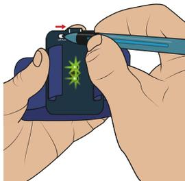
Wenn Sie den Sensor ausschalten möchten, um zu verhindern, dass die Batterie leer wird, schalten Sie den Sensor mit dem ON/OFF-Schalter aus. **Beachte: Der Sensor kann nicht geladen werden, wenn er ausgeschaltet ist.**
