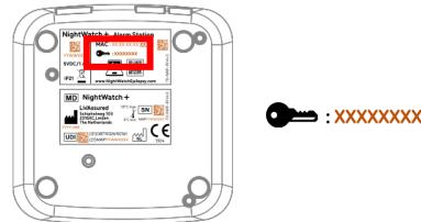
Nell'interfaccia web, alla voce "Password di amministrazione", inserire "DAS" seguito dal codice di 8 caratteri (DAS#####) per accedere all'interfaccia di configurazione del DAS.
